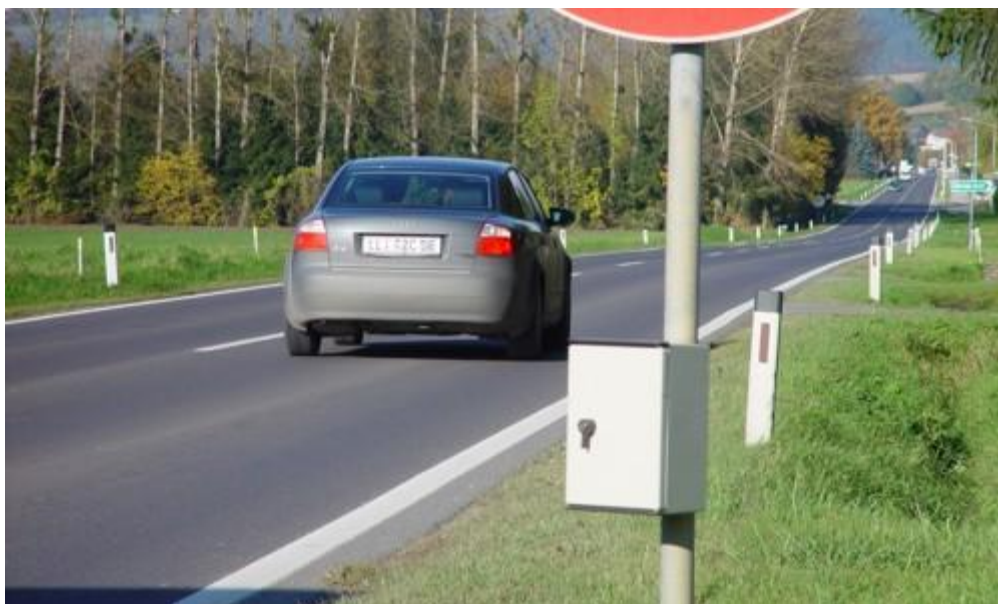
Slika 5.1 – Položaj uređaja Sierzega SR4 prilikom merenja
